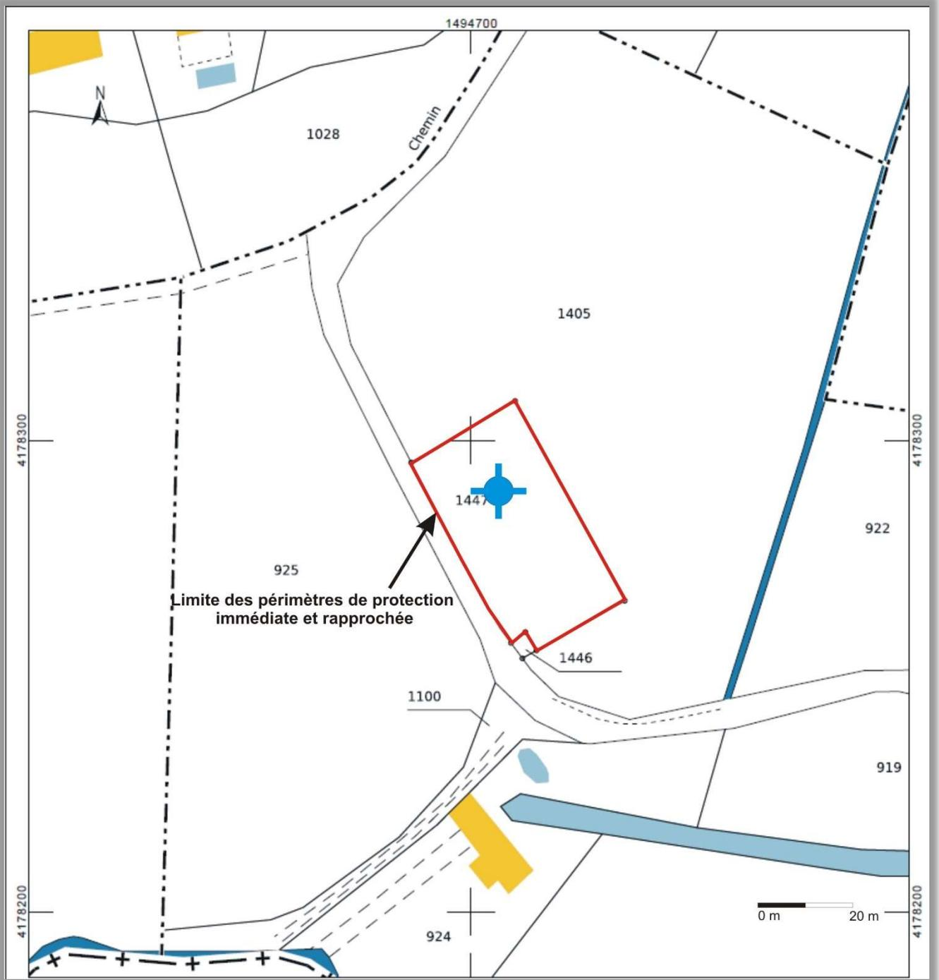
Figure 4 : Tracé des périmètres de protection immédiate et rapprochée du forage du Moulinot sur plan cadastral
